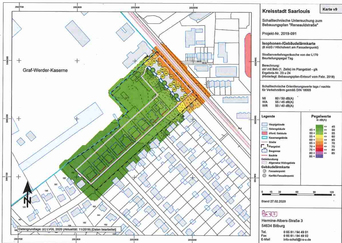
Abb. 6: Auszug aus dem schalltechnischen Gutachten – Verkehrslärmeinwirkungen im Plangebiet, Beurteilungszeitraum „Tag“ in 8 m über Gelände
