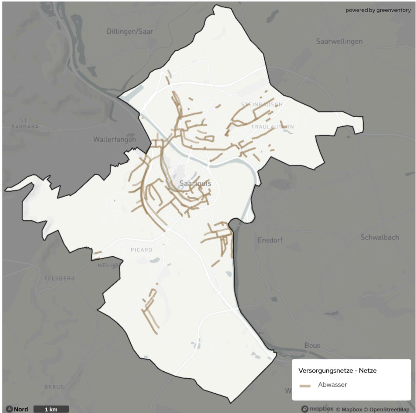
Abbildung 22: Abwassernetze mit Mindestnenngröße DN800
