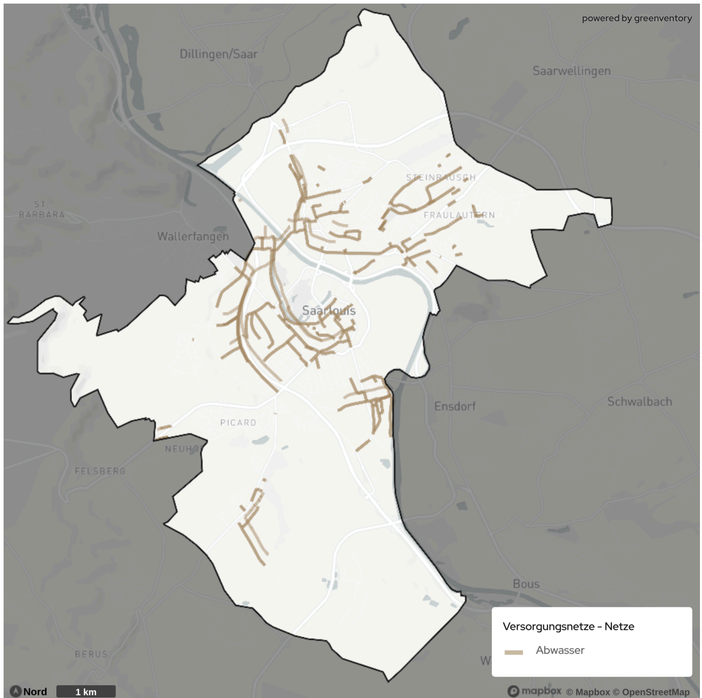
Abbildung 22: Abwassernetze mit Mindestnenngroße DN800
