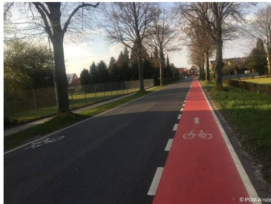
Abb. 5-28: Links: Beispiel für gemeinsamen Einsatz eines Schutzstreifens und einer gegenüber liegenden Piktogrammreihe auf der Fahrbahn (Harenberg, Region Hannover); rechts: Beispiel zur Anwendung in Saarlouis (Heiligenstraße, Roden)
