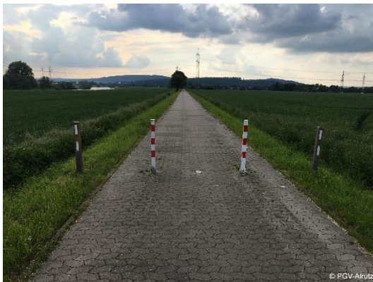
Abb. 5-34: Umklappbare Poller in hoch- und runtergeklapptem Zustand (Weserradweg, bei Hameln)
