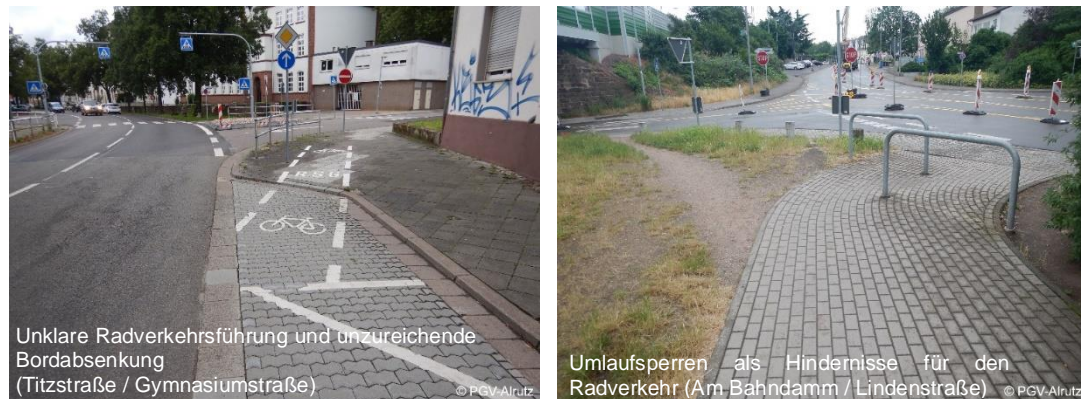
Abb. 3-10: Hindernisse und unklare Führungen des Radverkehrs
