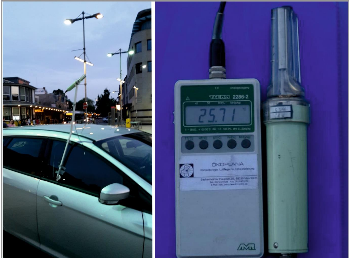
Abbildung 21: Messfahrzeug Ford Focus Combi und Psychrometer THERM 2286-2 der Fa. Ahlborn
