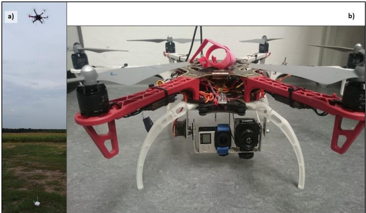
Abbildung 20: (a) Messsystem aus Hexakopter DJI Flamewheel 550 mit angehängter Radiosonde DFM-06 von GRAW. (b) Hexakopter Flamewheel 550 Nahansicht mit Aufhängung für Fotokamera der Marke GoPro und Infrarotkamera von FLIR
