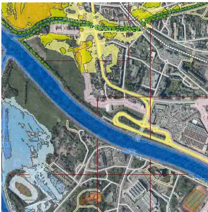
Abb. 6: Ausschnitt aus Hochwassergefahrenkarte HQ 100, Geoportal Saarland
